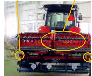
元からある灯火器類が最外側から 40 cm以内でない例
